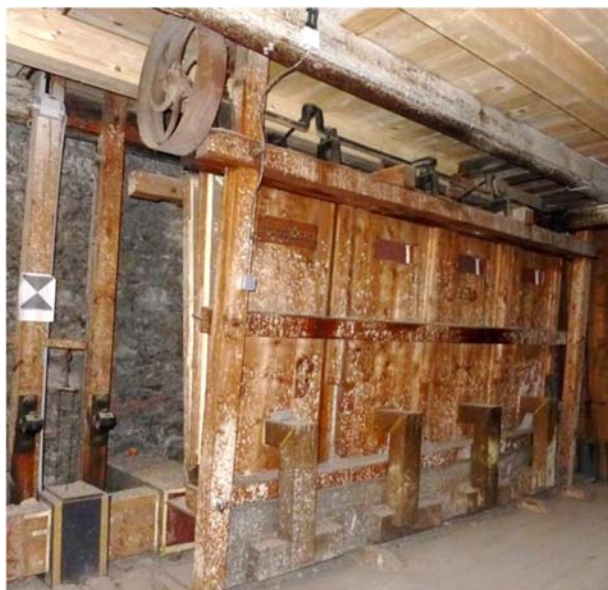
Schöpfbalg mit Transmissionsantrieb von 1910
