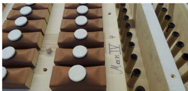
rekonstruierte Taschenlade für das vierte Manual
