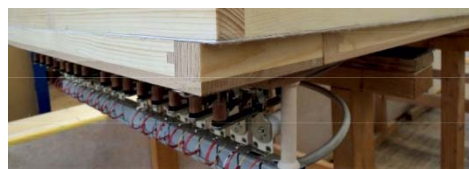
Die neue Windlade für die auf a^4 ausgebaute Super-(Oktav) Koppel
